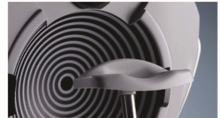
Кольца Пласидо -Измерение радиуса кривизны роговицы
